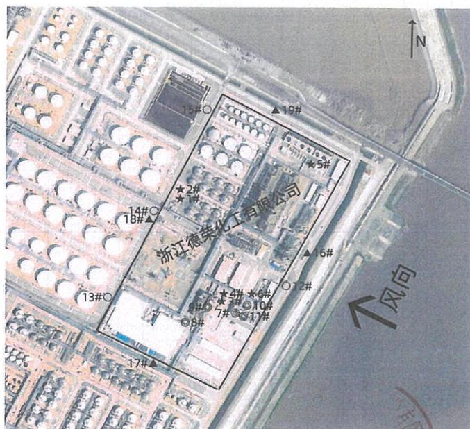
◎-有组织废气采样点；★-废水采样点
