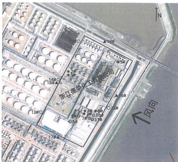
◎-有组织废气采样点；○-无组织废气采样点；★-废水采样点；▲-工业企业厂界环境噪声检测点
